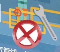
不得擅自改动、改装燃气管线、灶具等设施,更换气瓶要与管线连接牢靠,并检查是否漏气。
