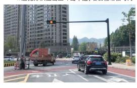
为缓解环岛主流车辆拥堵,采用在环岛东侧上 游增设辅助信号灯,并采用溢出感应控制联动,一 旦发生拥堵,及时启动辅助红灯。辅灯在常态情况 下采用黄闪控制,给驾驶员以警告路口和注意行人 的作用。
