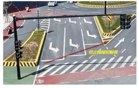
为充分利用路口空间,减少距离O(环岛)+Y(信 控路口)相互影响,缩短排队长度,采用停止线梯形 前移,以充分利用安全空间。同时,为避免3条左转 车道汇入凤凰北路两出口车辆行车轨迹影响,采用 出口增加辅助加宽空间,确保在路口内不拥挤,并 增设导向线引导车辆规范行车,减少刮擦交通事 故,并提升通行效率。
