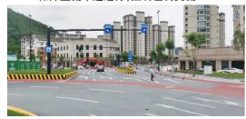
通过右转不受控渠化岛理念,将上桥直行车辆 分离,仅维持左转车辆排队等候,并设置三条左转 车道。
